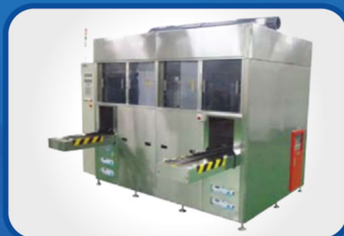
เครื่องล้างอัตโนมัติด้วย ไอสารละลาย ACE-4108RA
